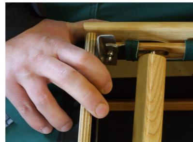
Verbindung Waschbordleiste hinten mit Klappbeschlag
