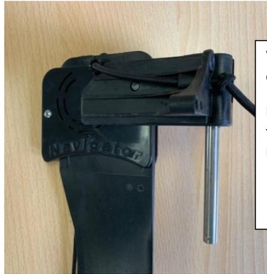
Wickeln Sie das Band vom Steuerblatt ab, dies dient zum späteren hochziehen.
