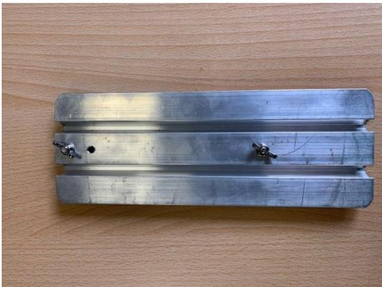
Die Steuerschiene ist an der Bodenleiter mit den mitgelieferten Schrauben und Flügelmuttern zu befestigen, dabei können Sie die Position der Schiene selbst festlegen. Bohren Sie einfach mit einem 5-er Bohrer 2 Löcher in ihre Bodenleiter.
