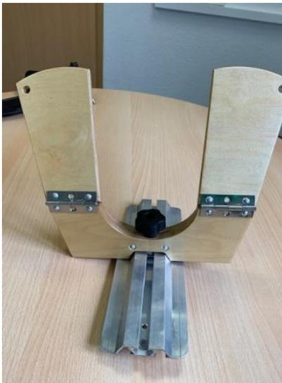
Danach führen Sie die angefasste Schraube in die Schiene und befestigen mit dem Sterngriff die Pedalerie.
