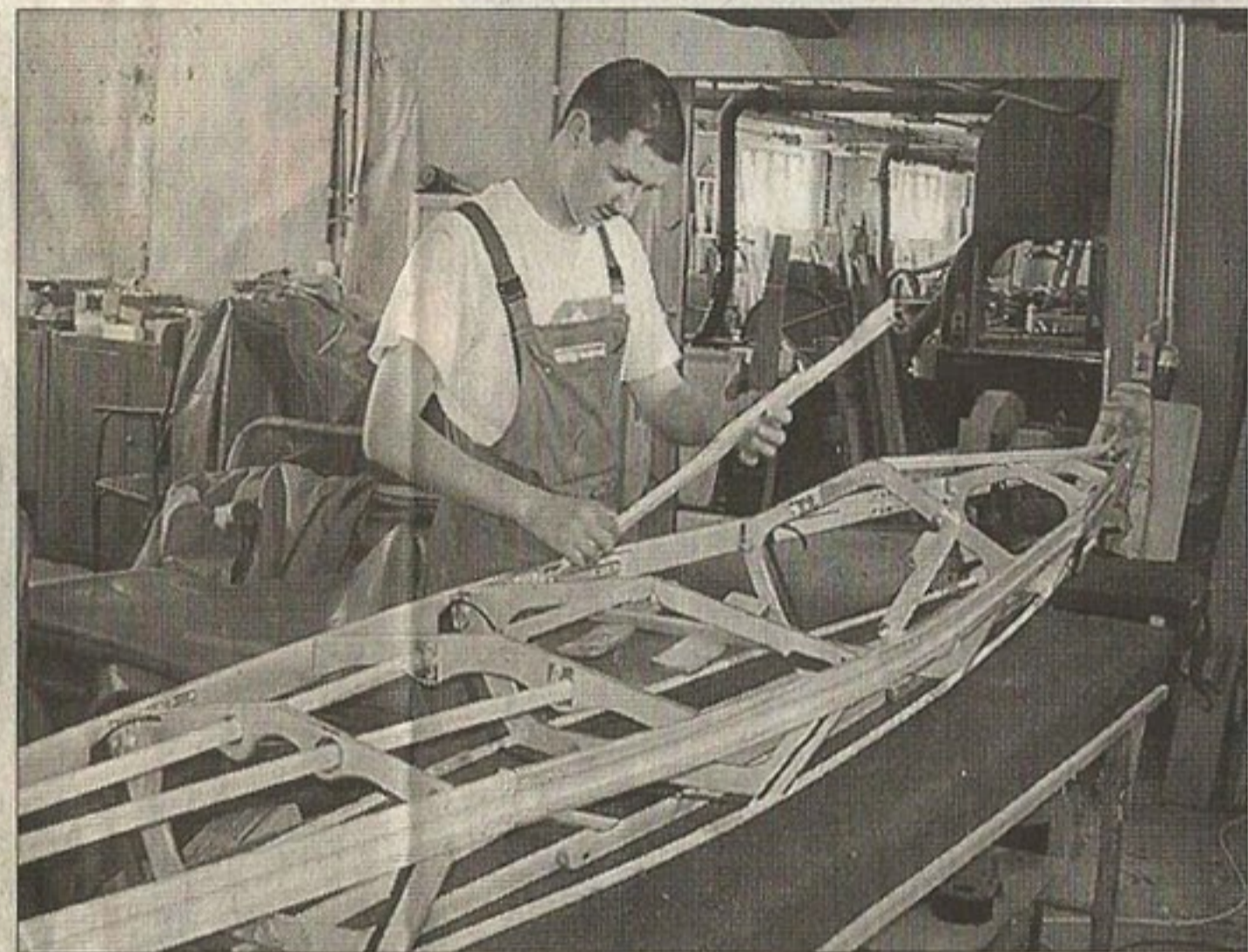
Enrico Seidel, Leiter der Abteilung Bootsbau, montiert das Holzgerüst eines Faltsboots vom Typ „Single 2 000“.
